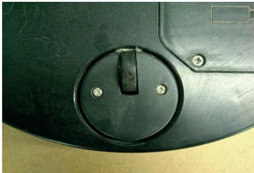
2: Rimuovere capelli e polvere. Durante il processo, assicurarsi di non danneggiare il cavo PCB.
